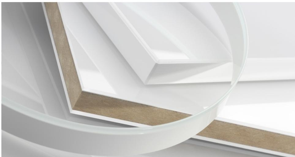
Rehau ha ampliato la linea di laminati per arredo Rauvisio con la nuova versione crystal, costituita da una sottile lastra di polimetilmetacrilato trasparente spessa 2 mm coestrusa con uno strato di ABS spesso solo mezzo millimetro, applicati su un pannello MDF.
