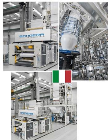
L'impianto coex3 è in grado di produrre film per sacchi industriali HDB e FFS, per laminazione e converting, back-sheet non traspiranti e film estensibili.
