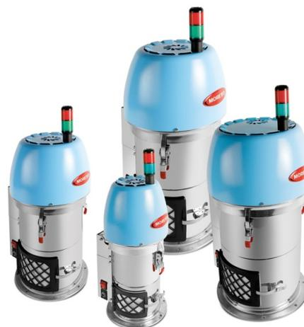
Il nuovo design integra l'elettronica negli apparecchi, senza cavi esterni, mentre il coperchio è ora dotato di apertura assistita come protezione dalla chiusura accidentale. Una lampada LED segnala in modo visibile lo stato macchina, anche da lontano.
