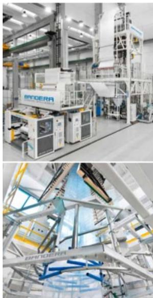
**PACKAGING FLESSIBILE.** La Open house ospiterà anche una linea per film soffiato Smartflex 22 HP Plus con larghezza utile di 2.000 mm e spessori da 20 a 200 micron, destinata alla produzione di imballaggi flessibili in polietilene con produttività fino a 500 kg/h.
