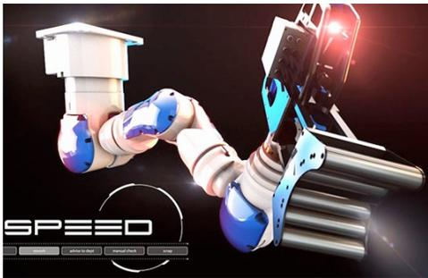
OLTRE L'ISPEZIONE MANUALE. CVA è un sistema automatico di analisi del pneumatico che si avvale di tecnologie innovative di visione artificiale ed automazione. L'ispezione viene oggi svolta manualmente e consiste nell'osservare tutte le zone, interne ed esterne, di ogni pneumatico prodotto, controllando con elevata accuratezza l'esistenza di eventuali difetti di tipo visivo.
