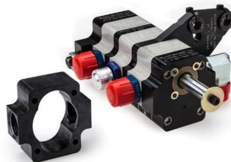
L'obiettivo è sostituire quanti più possibile pezzi in metallo con altrettanti in tecnopolimero per ridurre il peso del propulsore a soli 67 chilogrammi, 40 in meno di uno tradizionale.
