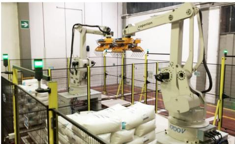
COME FUNZIONA. I sacchi vuoti, posizionati su due pile, vengono presi dal robot e collocati nella posizione di riempimento, dove per gravità il materiale scende dai contenitori posti nella parte superiore della cella. L'intero processo, compresa la chiusura dei sacchi, è gestito in modo automatico. Mediante codici a barre, viene identificata la commessa e impostati i parametri per la linea
