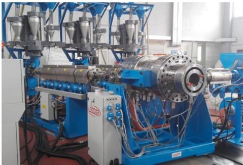
La testa è progettata per produrre tubi di grandi dimensioni, con possibilità di variare la configurazione degli strati in funzione delle mutevoli esigenze di mercato: 3 strati con sistema di distribuzione a spirali elicoidali. La testa è termoregolata attraverso una centralina che mantiene la temperatura costante durante il processo produttivo (sistema Terax). A detta del costruttore, non si verificano fenomeni sagging e viene mantenuta una perfetta
