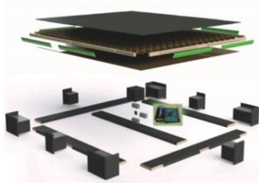
LOGISTICA 4.0. La rilevazione dei dati può avvenire a distanza, con ricevitori montati nelle infrastrutture logistiche e sui veicoli, oppure attraverso uno smartphone, avvicinandolo al pallet. In questo modo è possibile una gestione ottimale delle palette: quelle inutilizzate possono essere recuperate e reimpiegate, si riducono i furti o le perdite ed è possibile programmare in modo efficiente la manutenzione e la sostituzione delle unità danneggiate, anche
