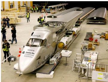
**RINFORZI LEGGERI.** North Thin Ply Technology (NTPT), con sede a Penthaz (Svizzera) ha invece fornito i prepreg in fibra di carbonio da cui si è partiti per creare i singoli elementi: grazie alla bassa densità di preformati e nastri (30-600 g/m<sup>2</sup>), si è potuto alleggerire l'aeromobile, fino a raggiungere poco più di 2,3 tonnellate, quanto un furgoncino o un SUV, nonostante l'apertura alare sia comparabile con quella di un aereo di linea.
