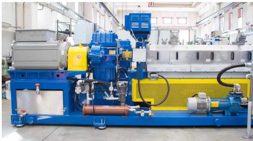
Ben conosciuta nel mondo del masterbatches e compounding, in Italia e all'estero, per i suoi impianti e estrusione bivate corotanti ad alte prestazioni, la milanese Comac ha scelto di esporre al K2016 (Hall 1 D42) un estrusore EBC 50 dotato di vite da 50 mm, L/D=40, con profilo ottimizzato per la produzione a base di PET o poliammide destinato ad applicazioni tessili (gradi fibra). La capacità produttiva arriva 500 kg/h in funzione del materiale processato.
