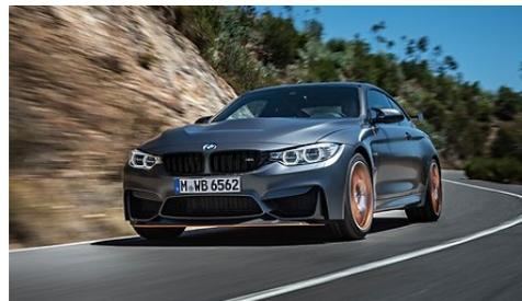
Realizzato con il sistema MTR 760, a reticolazione rapida, in collaborazione con C-Con e Läßple, il cofano ha portato ad una riduzione di peso del 40%, garantendo al contempo finitura in Classe A e superamento del crash test. Il composito Solvay può essere formato con le stesse presse utilizzate per lo stampaggio di lamiera, ottenendo forme tridimensionali anche complesse.
