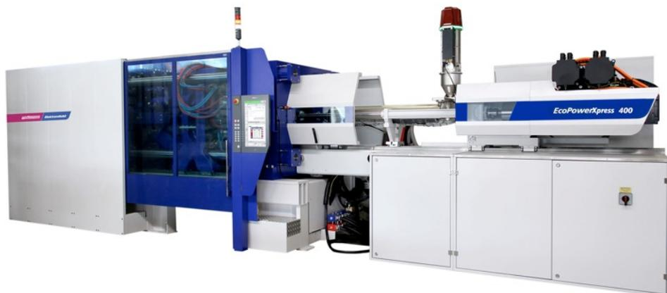
Tra le novità annunciata da Wittmann Battenfeld per il K2016, spicca la nuova gamma EcoPower Xpress, presse ad iniezione ad azionamento completamente elettrico per applicazioni di packaging e stampaggio veloce di pezzi a parete sottile, grazie alla presenza di azionamenti ad elevata dinamicità e di un gruppo di chiusura ottimizzato per cicli molto veloci, ma al tempo stesso precisi. L'uso di servoazionamenti per gli assi principali garantisce anche bassi consumi energetici.
