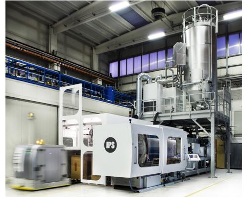
PRESSA DA 220 TON. La linea si basa su una pressa ad iniezione da 220 tonnellate per cicli veloci, dotata di sistema di chiusura a ginocchiera ad azionamento idraulico, abbinato ad un gruppo di iniezione elettrico per coniugare alte prestazioni e risparmi energetici. Il robot di estrazione preforme, integrato nella pressa, consente, tramite una mano di presa a tre stazioni, il post-raffreddamento delle preforme prima dello scarico.
