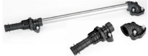
**SOTTOCOFANO CAMION.** Il riconoscimento è stato assegnato al corpo della valvola e al gomito che collegano la pompa dell'olio al carter, montati su un veicolo industriale del gruppo Daimler. Nel corpo valvola è integrata una valvola di non ritorno che impedisce lo svuotamento dei condotti olio nel carter a motore fermo. In questo modo, all'accensione del motore, si ottiene un aumento più rapido della pressione dell'olio ed un immediato trasferimento ai cuscinetti.
