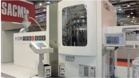
Amcor Rigid Plastics ha installato presso lo stabilimento di Youngsville, negli Stati Uniti, una nuova macchina CBF20 (Compression Blow Forming) con stampo a 20 cavità, fornita dal gruppo Sacmi, per la produzione di flaconi farmaceutici in HDPE. Il produttore americano di packaging utilizza dal 2012 questa tecnologia, nella versione a 12 cavità, grazie ad un accordo di partnership con il costruttore
