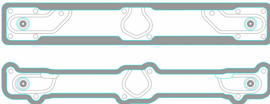
Come si evince dallo schema riportato sopra, il volume del nuovo hot-runner ECOflow (immagine in basso) è stato ridotto di un terzo rispetto alla versione standard (in alto), ovvero 2.340 cm<sup>3</sup> invece di 3.511 cm<sup>3</sup>, e un risparmio simile si è avuto per il peso.
