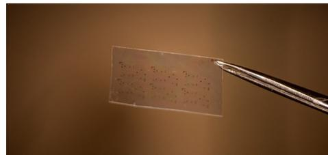
PIÙ VELOCE. Il transistor opera per la prima volta a frequenza sufficientemente alte (20 MHz) per essere impiegato nel campo delle etichette intelligenti, dei dispositivi indossabili per la diagnostica medica e il monitoraggio dell'attività sportiva, l'indirizzamento dei display flessibili ad alta risoluzione e delle fotocamere digitali plastiche, leggere e conformabili.
