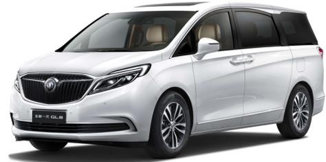
Prodotti da Ningbo Shentong Auto Decorations, i finestrini sono stampati mediante iniezione-compressione utilizzando la resina trasparente Lexan PC per la parte vetrata e la lega PC/ABS Cycoloy per la cornice opaca, entrambe fornite da Sabic. Un coating indurente siliconico protegge la lastra dall'abrasione e dagli agenti atmosferici.
