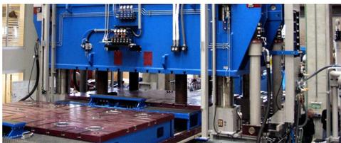
**PRODUTTIVITÀ VARIABILE.** Il tempo di polimerizzazione delle parti in HP-RTM può essere modificato, aumentando la temperatura dello stampo, da 180 a 90 secondi, mentre i tempi di iniezione sono, in linea di massima, inferiori a 30 secondi, con la tendenza a ridurre entrambi i parametri per
