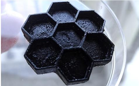
Un team di ricercatori italiani è riuscito a produrre con una stampante 3D commerciale, di tipo stereolitografico DLP (Digital Light Processing), alcuni pezzi utilizzando un composito ottenuto rinforzando con nanotubi di carbonio a parete multipla (0,3%-0,5% in peso) una matrice a base di fotopolimeri acrilici. Stabilità di dispersione e viscosità - due aspetti critici che risentono dell'aggiunta di nanotubi - sono
