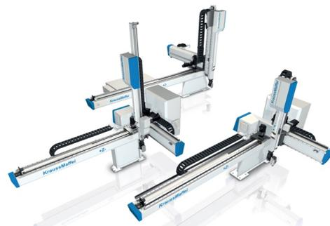
La gamma comprende tre modelli - LRX 50, LRX 100 e LRX 150 - progettati per garantire ridotti tempi di ciclo, precisione di posizionamento e affidabilità quando affiancati a presse idrauliche od elettriche.
