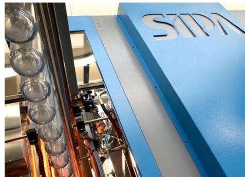
Un'altra caratteristica innovativa - segnala il costruttore - è il nuovo sistema di apertura e chiusura della pressa di soffiaggio, ora con azionamento diretto con motoriduttore brushless, così da poter modulare l'ampiezza dell'apertura in funzione del contenitore da soffiare, a vantaggio della flessibilità produttiva.
