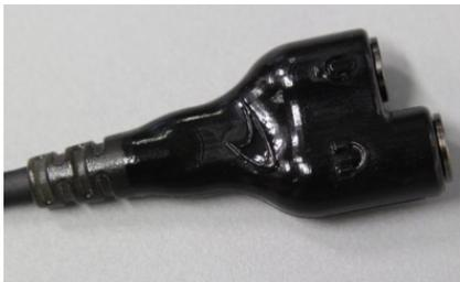
**COLLETTORE E MANICOTTO.** Avvalendosi di una stampante 3D Fortus 450mc Production (FDM) alimentata con poliammide rinforzata con fibra di carbonio (Nylon 12CF FDM), McLaren Honda ha realizzato in sole 4 ore il connettore strutturale che collega l'impianto idraulico (foto in alto), componente che con i processi di produzione tradizionali avrebbe richiesto due
