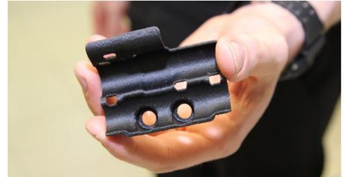
Sull'edizione 2017 del bolide da corsa MCL32 sono stati realizzati mediante stampa 3D il collettore dell'impianto idraulico, il manicotto flessibile per l'installazione del cablaggio radio, condotti di raffreddamento freni e parte dell'alettone posteriore. Per accelerare ulteriormente i cicli di progettazione e produzione, McLaren Honda porterà una stampante Stratasys uPrint SE Plus a bordo pista, consentendo così al team di produrre parti e attrezzi su richiesta in fase di test e di gara.
