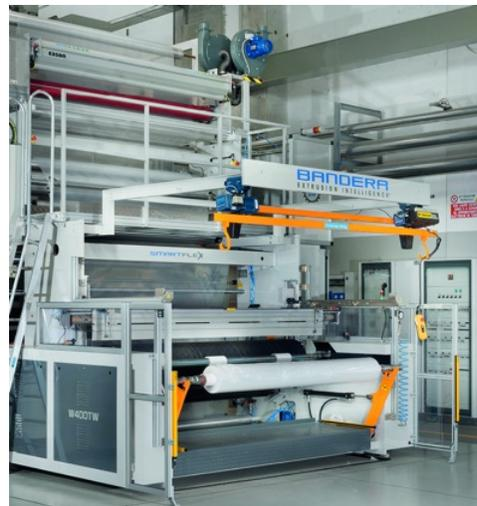
La linea è in grado di produrre film di alta qualità con larghezza netta fino a 2.200 mm in una gamma di spessori da 20 a 200  $\mu\text{m}$ , con una produttività che raggiunge i 550 kg/h.
