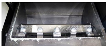
Sopra, una camera autopulente dei granulatori TRIA Sotto una camera standard
