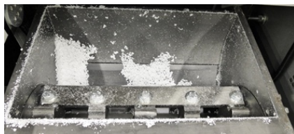
Sopra, una camera autopulente dei granulatori TRIA Sotto una camera standard
