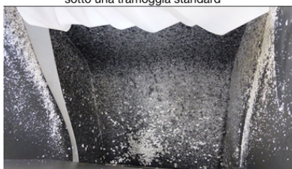
Sopra tramoggia autopulente, sotto una tramoggia standard
