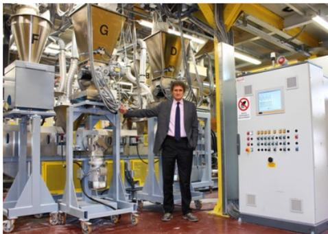
**NUOVI INVESTIMENTI** - Con il recente avvio di una linea di estrusione-compound e di un impianto di confezionamento dei prodotti, la capacità produttiva del gruppo sfiora le 25mila tonnellate annue di compound a base di poliammidi, PBT ed acetalica cui vanno aggiunte circa 2.000 t/a di gomme termoplastiche e un migliaio di tonnellate di masterbatches colore e additivo.
