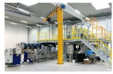
A questo scopo sono presenti due estusori di ultima generazione: TEX44αIII (bivite con diametro da 47 mm) e TEX30α (32 mm), che possono essere usati singolarmente o in tandem. Un terzo estrusore da laboratorio ad alimentazione laterale, TEX25αIII, è presente nel TEXenter a scopo dimostrativo: si tratta del nuovo bivite corotante da 26,5 mm presentato in anteprima europea al K2016.
