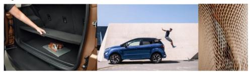
Per realizzare il piano regolabile del bagagliaio del nuovo SUV compatto Ford EcoSport, gli ingegneri della casa automobilistica statunitense hanno messo a punto una struttura alveolare, battezzata Honeycomb Shelf, costituita da uno strato di cartone riciclato, con celle a nido d'ape, interposto tra due strati di fibra di vetro.
