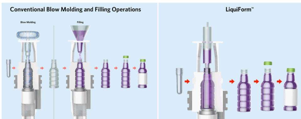
**PRIMO IMPIANTO INDUSTRIALE.** Amcor produce i flaconi di sapone liquido con una macchina costruita internamente. Si tratta, afferma il produttore di packaging, del primo impianto ad utilizzare il processo LiquiForm su scala industriale.
