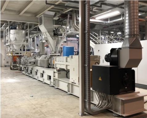
Il compoundatore varesino Rialti sta completando la messa in marcia di una nuova linea di estrusione-compounding, la quarta, destinata alla produzione di polipropilene rinforzato con fibra di vetro.
