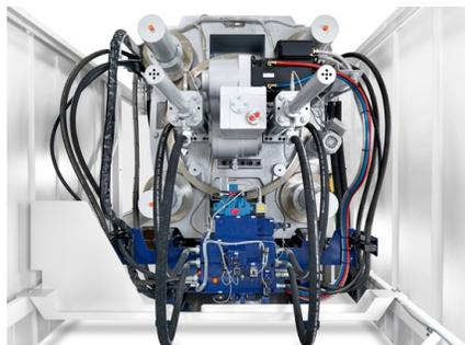
Con una forza di chiusura di 750 tonnellate ed azionamento elettrico, la Elios 7500-6000 scelta per la fiera è allestita per la produzione di confezioni per dolci con volume di 473 ml, utilizzando uno stampo a 8+8 cavità e automazione CBW, ottenendo un ciclo di 3,1 secondi.
