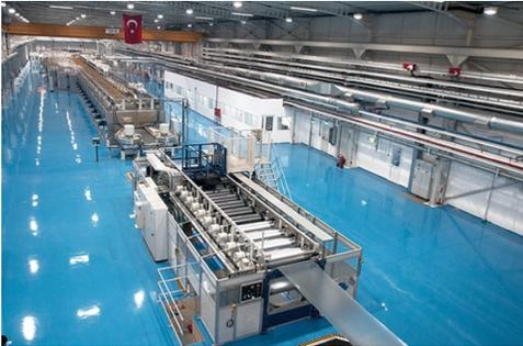
Polibak, società del gruppo Bakioglu Holding attiva dal 1994 nella produzione di film in polipropilene con due stabilimenti a Izmir, in Turchia, ha deciso di incrementare la capacità di film BOPP ordinando alla tedesca Brückner una nuova linea con larghezza di 10,4 metri e velocità di estrusione pari a 525 metri al minuto, per un output di oltre 7.400 kg/h di film a 5 strati.
