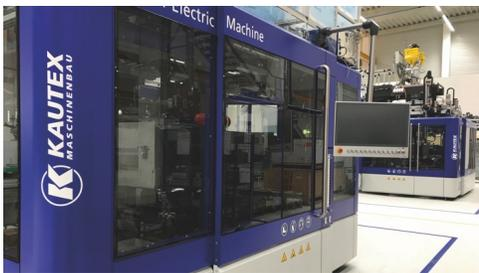
Dal gruppo tedesco Kautex Maschinenbau, Amcor ha invece acquistato un impianto per estrusione soffiaggio della serie KBB, anche in questo caso ad azionamento elettrico. La macchina soffierà flaconi per la casa e la cura della persona (bagnoschiuma, shampoo) con capacità da 118 a 946 ml.
