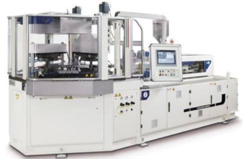
L'azienda fiorentina Meccanoplastica ha fornito allo stabilimento di Youngsville, negli Stati Uniti, una macchina per iniezione soffiaggio ad azionamento elettrico della serie Jet (foto a destra), destinata alla produzione di imballaggi medicali in polipropilene e HDPE, fiale con volume tra 7 a 50 ml.
