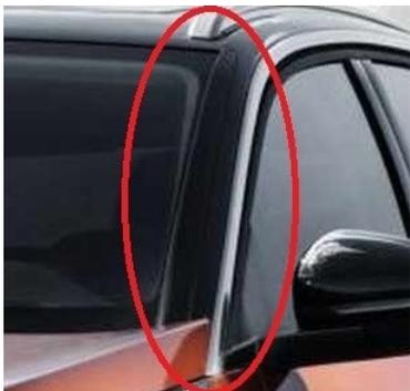
La tecnologia di stampaggio ColorForm di KraussMaffei e il nuovo grado Luran S KR 2864C di Ineos Styrolution (blend PC/ASA) sono stati utilizzati per la prima volta insieme per realizzare un componente di carrozzeria auto, il rivestimento del montante A del parabrezza.
