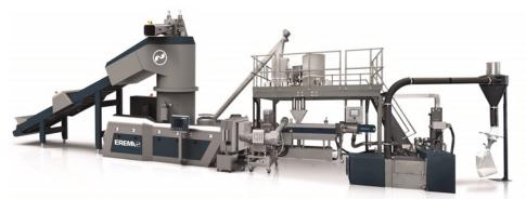
Il costruttore tedesco Coperion fornisce ormai da qualche anno alla austriaca Erema (impianti di riciclo) estrusori bivite che combinati con la tecnologia Corema consentono di eseguire, su un unico impianto, la rigenerazione e compounding di materie plastiche da sfrido o post-consumo. In questo modo, le aziende di riciclo hanno la possibilità di produrre autonomamente per poi rivendere sul mercato granuli pronti per una nuova trasformazione.
