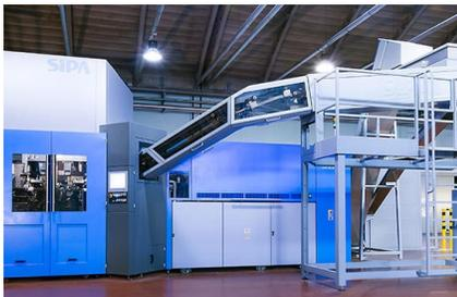
L'impianto XTRA 12 (nella foto) raggiunge una produttività per cavità fino a 2.550 b/h - afferma il costruttore veneto - assicurando ridotto consumo energetico, elevata flessibilità e facilità d'uso, nonché compatibilità con altre macchine a monte e a valle. Può infatti produrre bottiglie da 0,2 a 3,5 litri con diverse dimensioni di collo (28/38 mm), utilizzando due diverse corse della pressa: corta, per produrre bottiglie fino a 1,5 litri ad una
