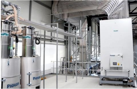
**LA SOLUZIONE PIOVAN.** Il sistema proposto parte dallo stoccaggio delle materie prime in 25 bin, contenitori in alluminio da 300 litri dotati di elettroserratura e di un sistema visivo, con spie di diverso colore, per indicare in modo immediato lo stato del processo. La tracciabilità e il controllo della correttezza delle operazioni parte da qui, con la scansione del codice a barre dei sacchi contenenti il materiale plastico che viene caricato nel silo; onde evitare
