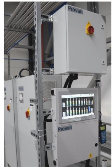
**TRASPORTO PNEUMATICO AD ALTA EFFICIENZA.** Terminata questa fase, il granulo viene trasferito alle presse mediante un sistema di trasporto in depressione con circuito indipendente rispetto a quello che alimenta i deumidificatori, con una pompa che alternativamente serve uno dei due circuiti (una seconda pompa è pronta ad entrare in funzione in caso di
