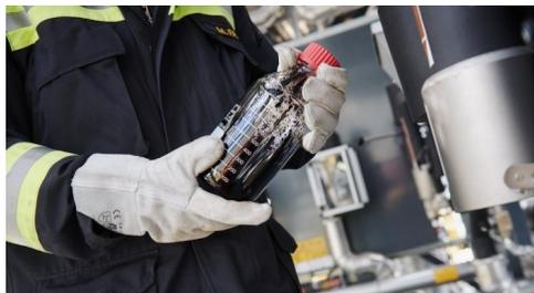
Il gruppo petrolifero OMV sta scalando il processo ReOil per la produzione di greggio sintetico da rifiuti plastici mediante pirolisi (cracking termico ad oltre 300°C), progetto avviato nel 2011 con un investimento, fino ad oggi, intorno ai 10 milioni di euro.
