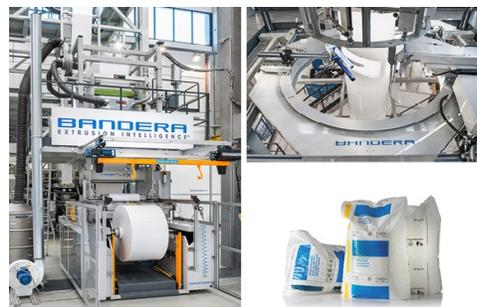
Tra gli sviluppi più significativi, l'introduzione sulle linee HDBFlex dell'anello di raffreddamento a triplo flusso che, grazie ad aggiornamenti a livello tecnico, combinato con il disegno delle teste di estrusione ed il controllo di spessore integrato, ha portato ad un significativo incremento della produttività, fino a a 450 kg/h, e ad un visibile miglioramento delle caratteristiche fisico-meccaniche del film.
