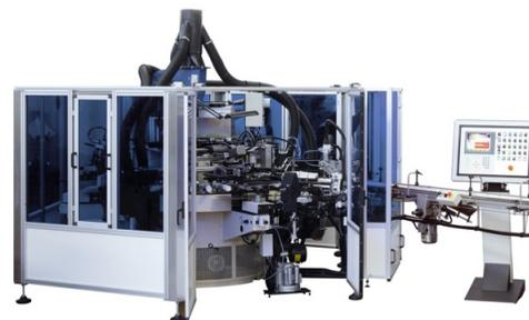
La configurazione della macchina prevede una torretta rotante intermittente a comando meccanico con 36 posizioni. Il layout orizzontale consente l'installazione di diversi accessori: oltre al sistema di rimozione delle cariche elettrostatiche e delle particelle di polvere depositate sulla superficie da decorare, ospiterà un avanzato sistema di ricerca periferica che permette di registrare ogni vasetto, puntualmente, nella stessa posizione.
