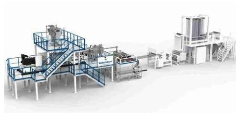
Il cuore della linea, come nelle versioni precedenti, è l'estrusore bivate REItruder, ora giunto alla terza generazione. Grazie alla presenza di pompa a vuoto con funzionamento a secco ad alte prestazioni (fino a 5 bar) e gruppo di degasaggio, la linea soddisfa i requisiti FDA per la produzione di film e foglie in PET 100% da riciclo, a contatto diretto con gli alimenti. Soddisfa anche i requisiti Efsa, la cui omologazione è affidata però all'utilizzatore.
