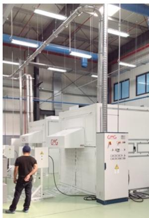
così da recuperare in linea lastre piene, termoformate e pezzi scarto. La macchina è in grado di trattare lastre di PET, polistirene, poliolefine
