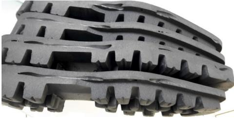
Il compoundatore di PVC, EVA e poliolefine Fainplast ha depositato una domanda di brevetto internazionale per un nuovo iniettore per presse ad iniezione che risolve il problema della formazione di buchi o canali all'interno delle suole fresate in EVA e copolimeri di etilene espandibili reticolabili.
