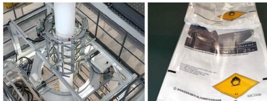
L'impianto, completamente accessorizzato, include la stampa flexografica in linea a 4 colori ed è destinato alla produzione di sacco industriale (tecnologia FFS) con alta produttività.
