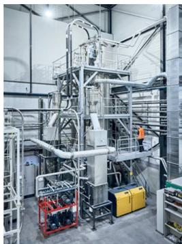
"Il PET riciclato svizzero vanta da diversi anni un eccellente livello di qualità - commenta Casper van den Dungen, Direttore di Poly Recycling -. Grazie al 'solid stater' (foto a sinistra) possiamo migliorare ulteriormente le caratteristiche tecniche del materiale, raggiungendo il livello del PET vergine, e produrre così bottiglie più leggere e più sottili. Ciò consente di utilizzare meno materiale nella produzione, con un ulteriore effetto positivo in termini ambientali".
