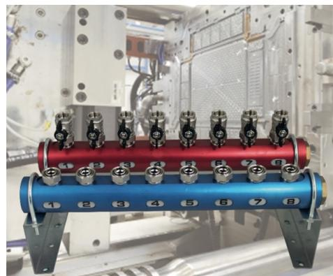
Per questa linea, Flowise ha studiato un sistema pratico e veloce di installazione e manutenzione, denominato "no teflon", che combina un codolo in ottone e ghiera con guarnizioni in gomma NBR o fluorurata a cui si possono abbinare valvole a sfera a passaggio totale o valvole di regolazione per un flusso parzializzato.
