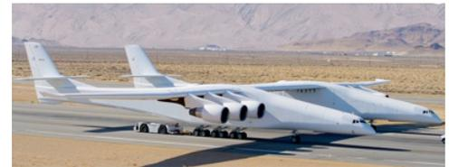
L'utilizzo di un aereo per il lancio dei satelliti offre numerosi vantaggi, poiché l'operazione è indipendente dalle condizioni meteorologiche, che causano spesso costosi ritardi. Per decollare, infatti, Stratolaunch ha bisogno solo di una pista sufficientemente lunga per il rullaggio, ma non sono necessarie rampe di lancio fisse.
