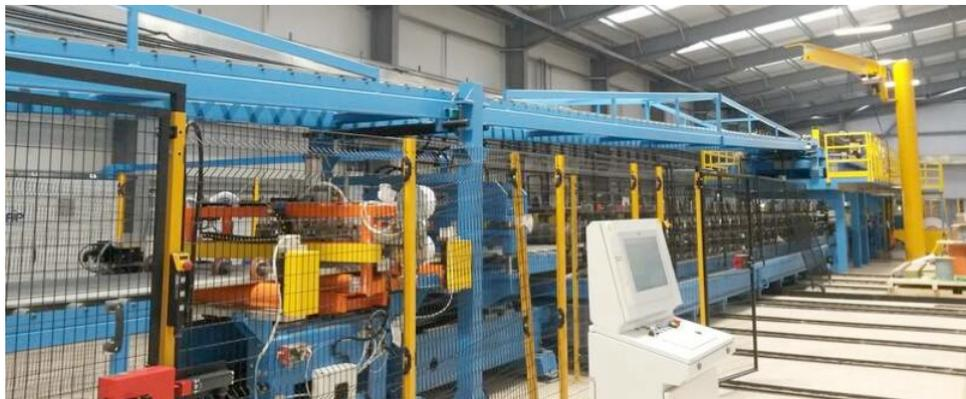
Il costruttore comasco SAIP ha fornito alla britannica Steadmans una linea completa per produzione in continuo di pannelli sandwich, in acciaio e poliuretano espanso, della famiglia Contitech.
