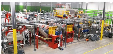
Per ottimizzare la qualità dell'output, gli imballaggi in plastica dovrebbero essere smistati automaticamente attraverso una serie di passaggi successivi. La rimozione dei contaminanti e la selezione degli imballaggi in base alla diversa tipologia di polimeri - eventualmente anche per colore e categoria di prodotto - sono prerequisiti per garantire un flusso di elevata qualità nelle successive fasi di riciclo.
